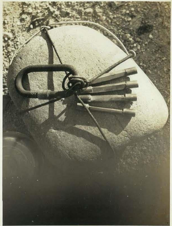
テストに用いた 15.5 kgr の石, なお石 上に乗っているのは テストに用いた 種々の角度のエッジ 上より 120°, 90°, 60°, 30°
