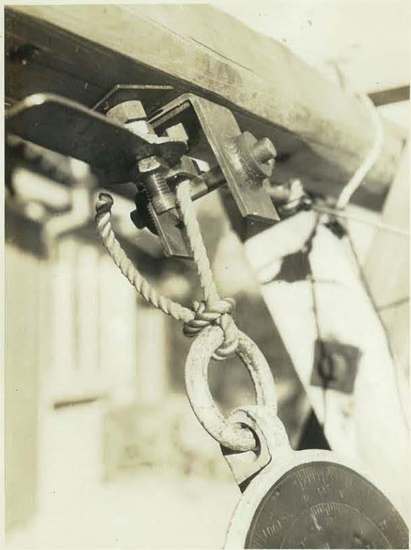
ヤガラ 上部につけられたエッジ 同じくエッジ上を往復運動 させている状況
